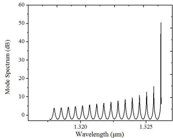
Fig. 3. Laser mode spectrum at 90 mA ( $T=80^\circ\text{C}$ ).
